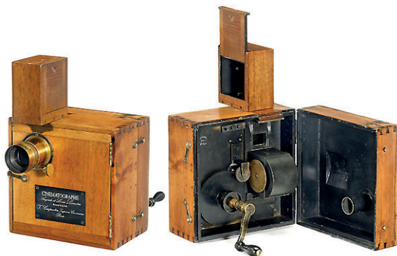
Cinematógrafo Lumière en modo filmación (izquierda) y en modo proyección (derecha).
